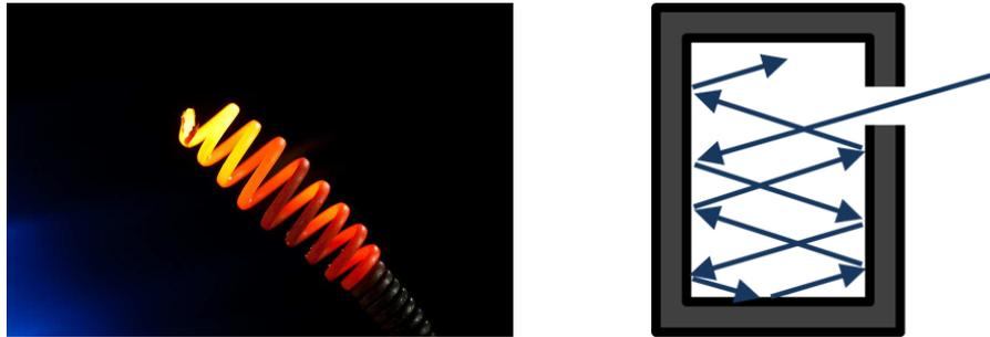
Figura 2.1: Metal caliente (izquierda) y modelo de cuerpo negro (derecha).
